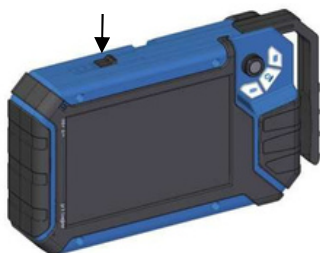
Figura 17: Botón pulsador para extraer la manija, marcado con una flecha.
