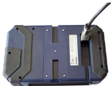
Figura 10: Conexión del cable de la cámara
