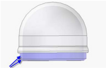
Figura 67: Montaje de la cúpula de la cámara
