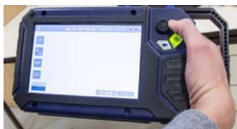
Figura 16: Con el asa extendida, es posible sujetar y manejar el monitor con una sola mano.
