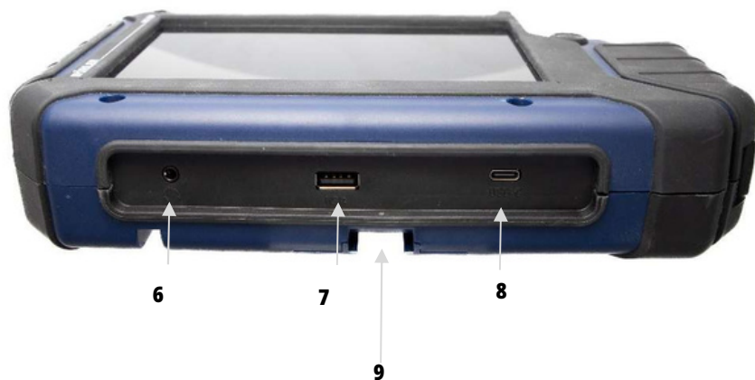
Figura 8: Parte inferior del monitor con tira de conexión
