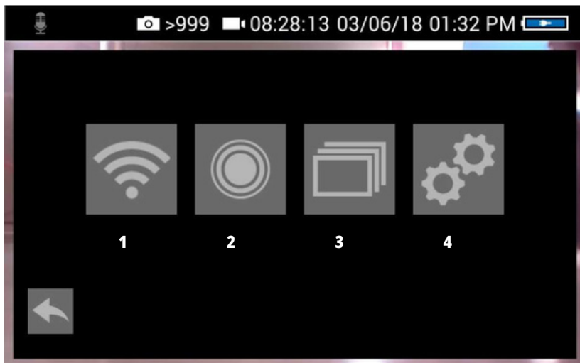
Figura 30: Menú del sistema con submenús WLAN (1), Detección de ubicación (2), Galería de imágenes y vídeos (3) y Ajustes (4)
