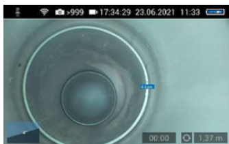
Figura 26: Ajuste de enfoque, se muestra la distancia.
